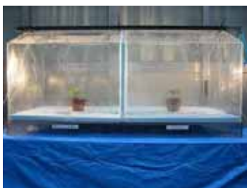
第4図：光触媒温室実験装置
